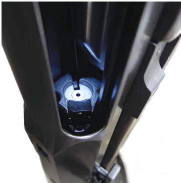
Planer Verschlusskopf der frühen Serie
