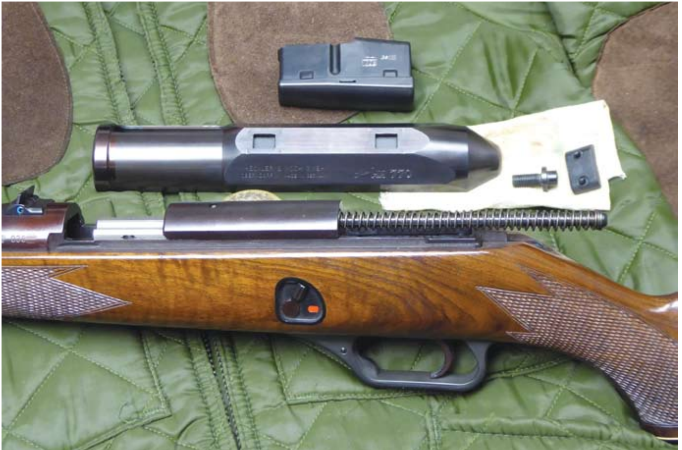
Oberteil abgenommen. Spindel und Pufferplatte auf weißem Tuch.
