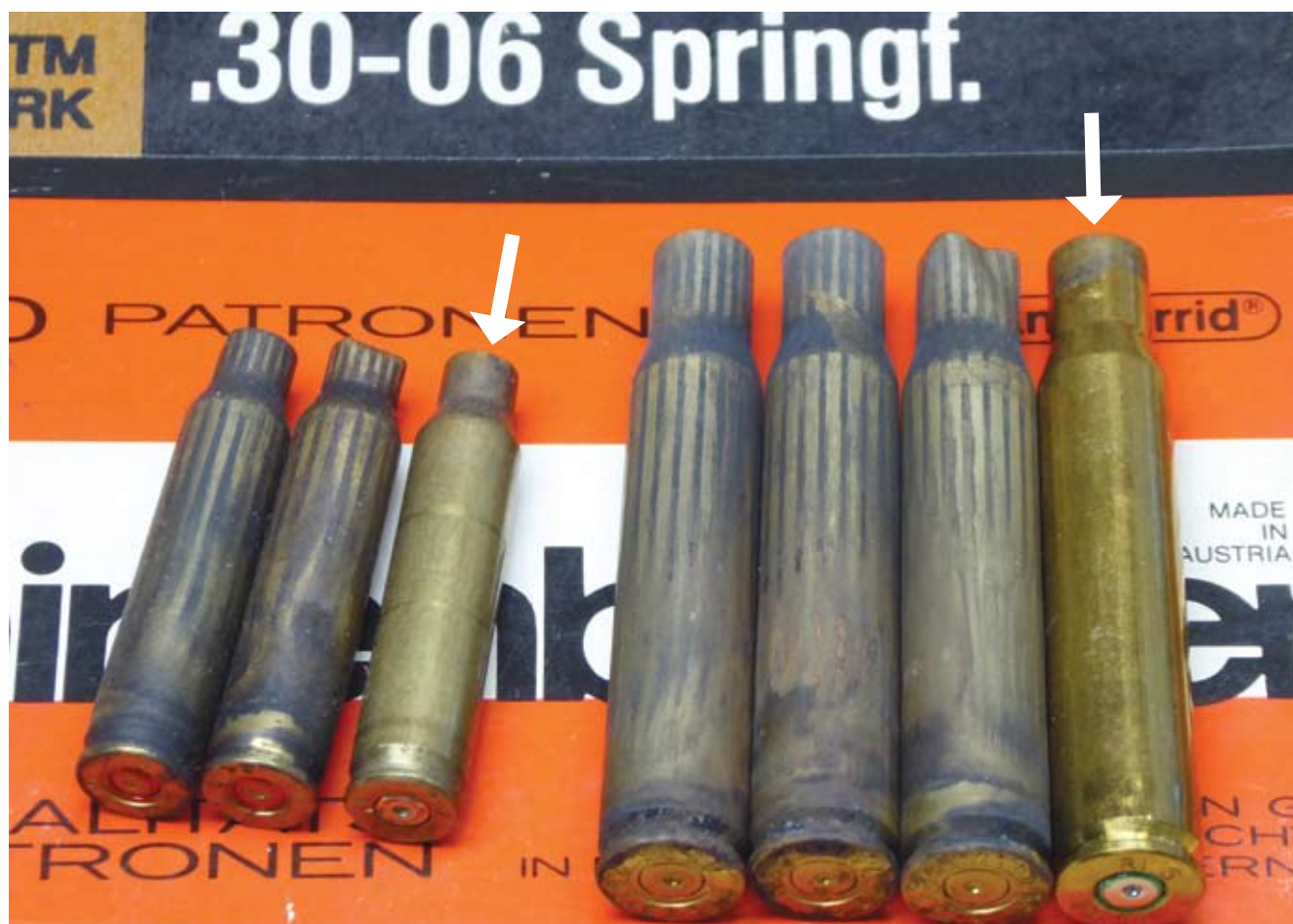
Links 2 ausgeworfene Hülsen (ca. 1980) aus HK 630 und rechts 3 aus HK 940. Bei beiden deutlich sichtbarer Eindruck des erhabenen Ringes des Verschlusskopfs neuerer Art am Patronenboden. Die beiden glatten Hülsen (siehe Pfeile) stammen aus herkömmlichen Patronenlagern.
