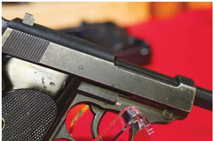
5-zackiger Stern: Kennzeichen des Zusammenbaus unter franz. Besatzung
