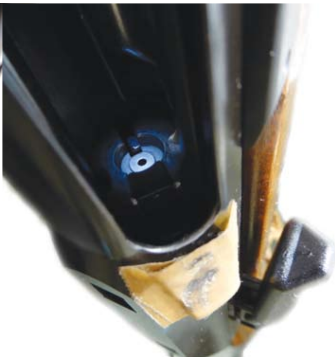
Verschlusskopf der späteren Serie mit erhabenem Ring um die Schlagbolzenöffnung.
