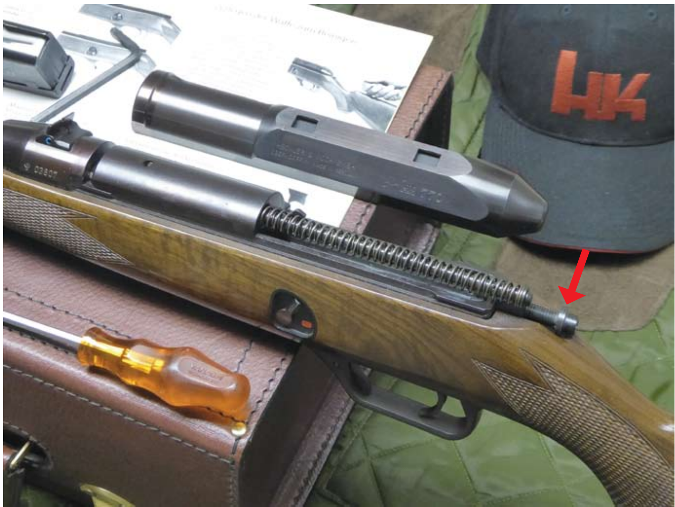
Nach Herausrauben der Spindel (Pfeil) kann der Oberteil abgenommen werden.
