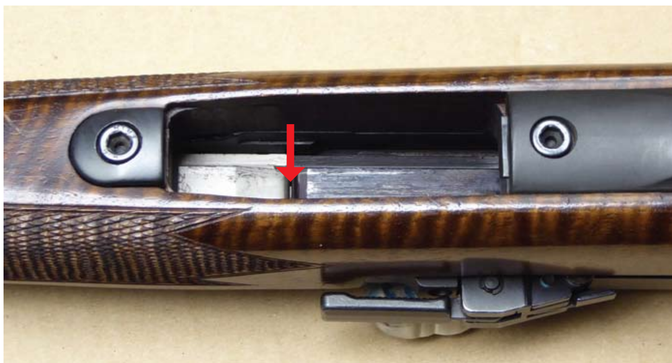
HK 770 Einblick von unten durch den Magazinschacht zur Kontrolle des Verschußabstands (Pfeil) der > 0 sein muß.
