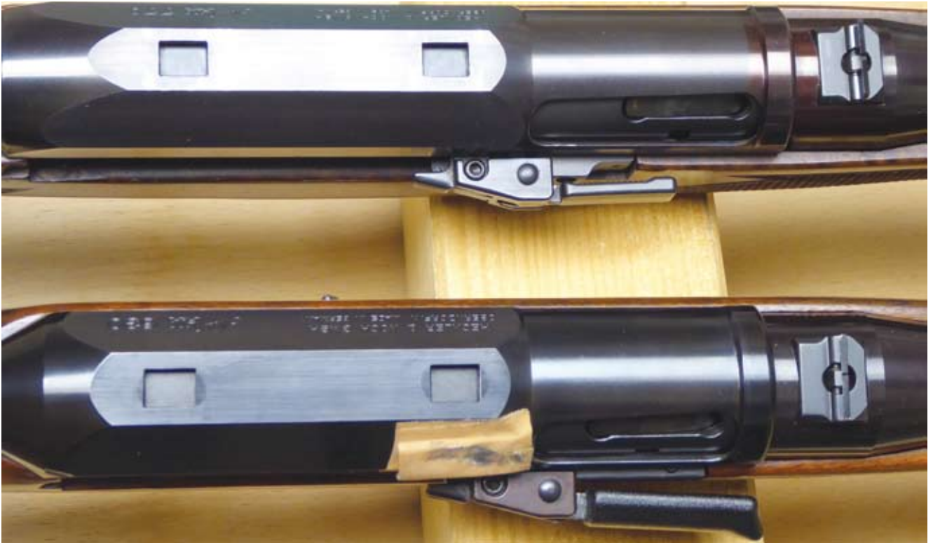
HK 770 mit Ladehebel der frühen Produktion darunter der verbesserte Ladehebel der späteren Serie bei HK 630. Das von mir angebrachte Pflaster mit Kunststoffeinfügung verhindert die Deformation der kraftvoll herausgeschleuderten Hülsen und den Messingabrieb am Oberteil.
